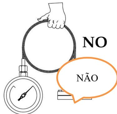
A diferença de nível entre o instrumento e o separador de fluidos causa um efeito hidrostático no elemento de medição e conseqüentemente uma variação na indicação do instrumento. Se for conhecido, essa diferença deve ser indicada ao solicitar, caso contrário, será necessário redefinir o instrumento no local.
